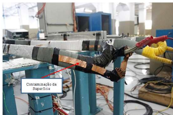
Figura 13 - Contaminação da superfície da bobina com uma fita de cobre.
