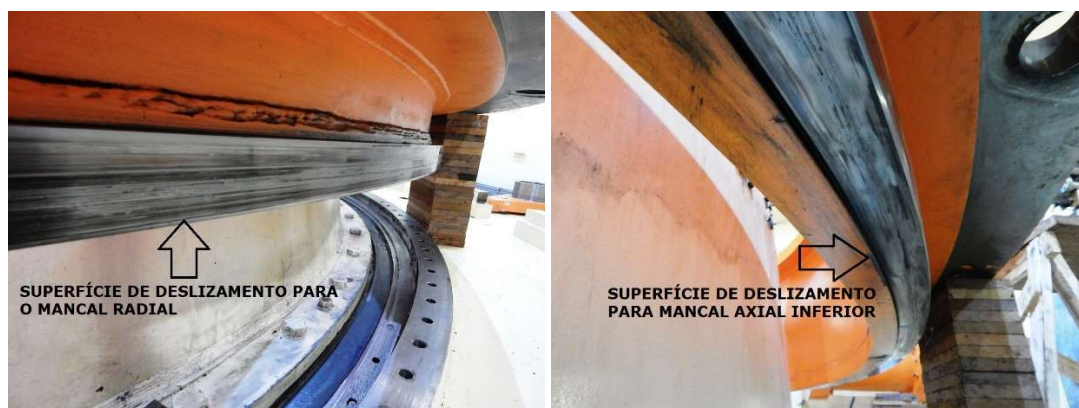
Figura 11 – Sulcos e arrastamento de material na superfície de deslizamento do anel de regulação.
