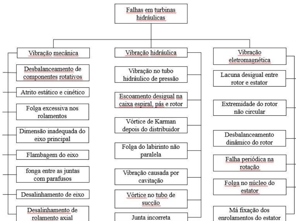
Figura 1 – Principais falhas em grupos geradores hidrelétricos devido à vibração. Fonte: (4) adaptado
