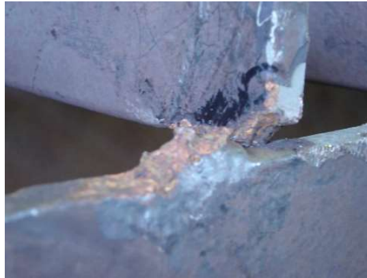
Figura 4 - Trinca em painel de grade original da UHE GJR
