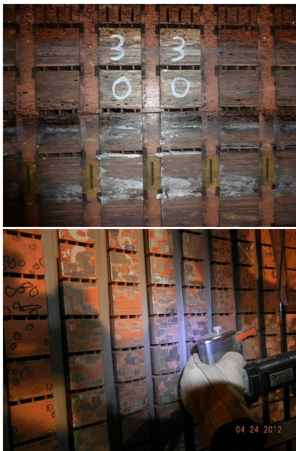
Figura 2 - Núcleo do estator: Inspeção visual e lixamento
