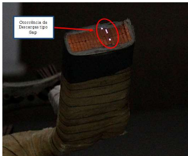
Figura 11 - Ocorrências das descargas entre barras com tensões diferentes.
