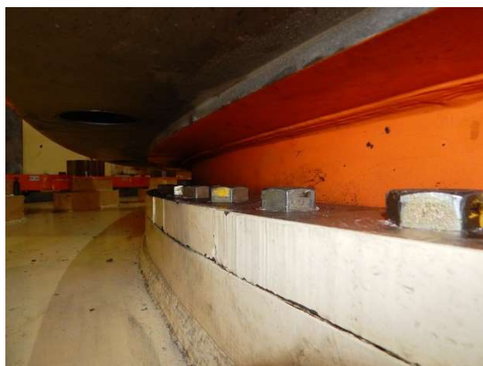
Figura 8 – Visão geral dos mancais, do anel de regulação, montados.
