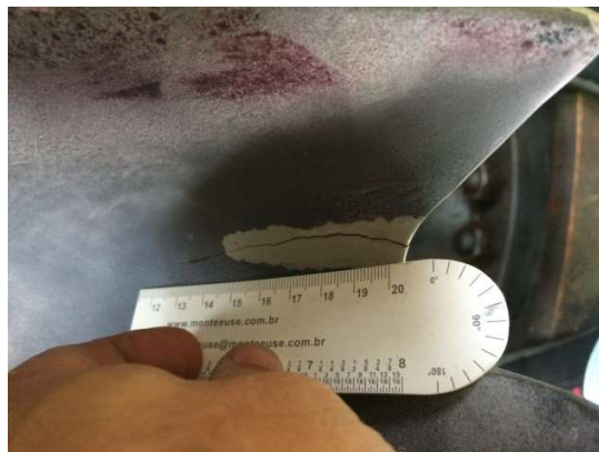
FIGURA 2 - Trinca nucleada e propagada em concha de rotor tipo Pelton da Usina Hidrelétrica Marumbi. (a) vista geral, (b) localização da trinca e (c) detalhe da trinca.
