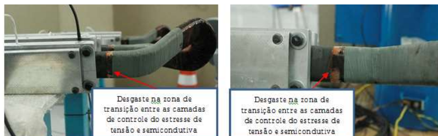
Figura 6 - (a) e (b) Indicativo de desgaste na zona de transição entre as camadas controle do estresse de tensão e semi condutiva em diferentes partes da bobina.
