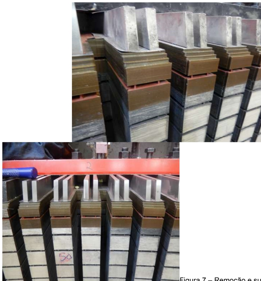
Figura 7 – Remoção e substituição das laminas danificadas
