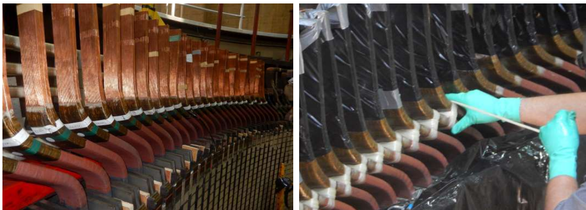
Figura 9 – Instalação do enrolamento do estator
