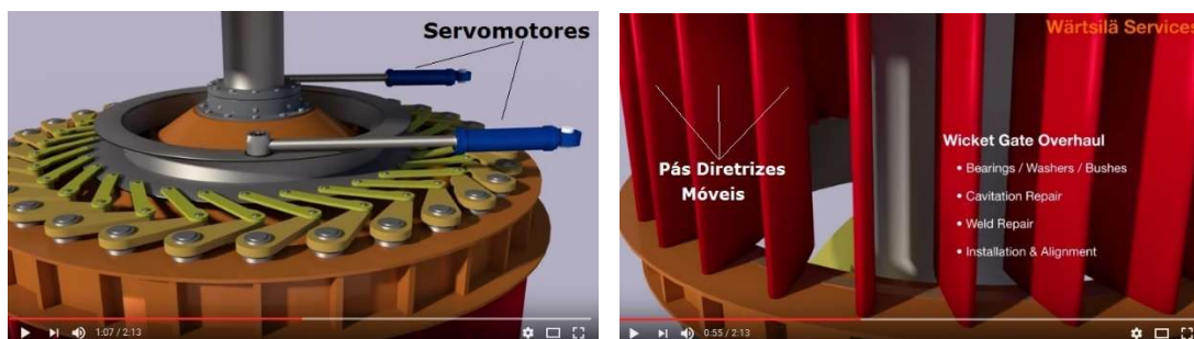
Figura 3 – Nesta ilustração o distribuidor da turbina encontra-se aberto.
