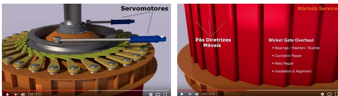
Figura 2 – Nesta ilustração o distribuidor da turbina encontra-se fechado. Em detalhe a esquerda, o anel de regulação encontra-se na cor cinza.
