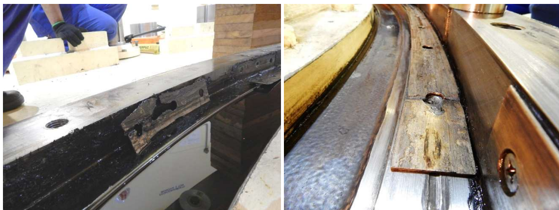
Figura 10 – Placas autolubrificantes radiais e completamente avariadas (a esquerda) e deformações nas placas autolubrificantes além do rompimento dos elementos de fixação (a direita).
