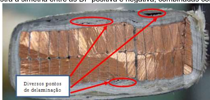
Figura 4 - Dissecção da bobina e constatação de delaminações.
