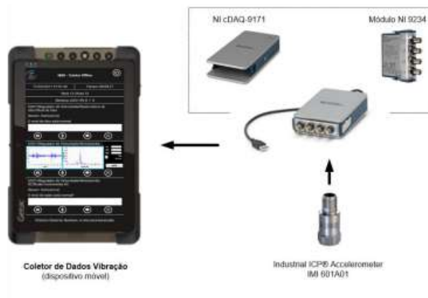
Figura 3 – Aquisição de dados de vibração
