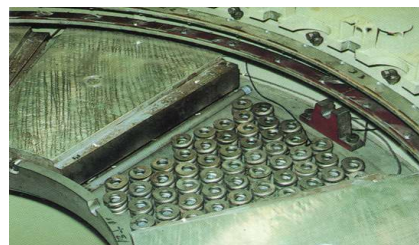
Figura 4 – mancal de escora de dupla camada e molas helicoidais
