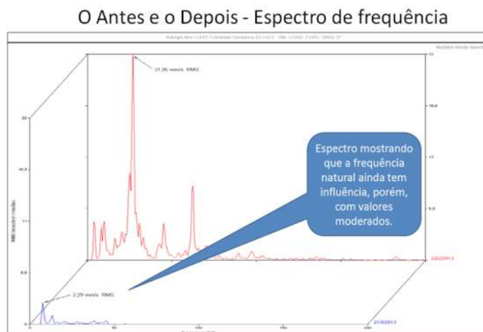
FIGURA 11 – Gráficos comparativo, espectro antes e após a instalação dos anéis
