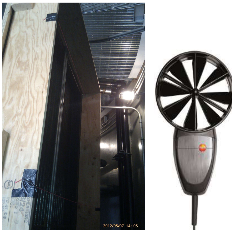
FIGURA 8 – Estrutura de madeira em volta do resfriador para medição da velocidade do ar e anemômetro tipo hélice
