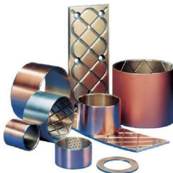
Figura 5 – Aspecto geral de buchas e placas autolubrificantes produzidas pelo processo de sinterização. Trata-se da tecnologia empregada no projeto do distribuidor da UHE GJR.
